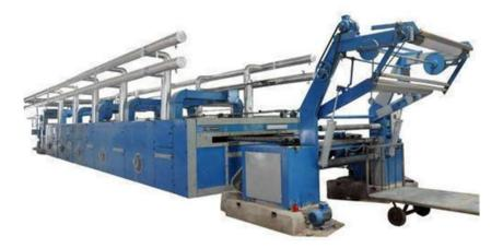
Fig.: Stenter machine
