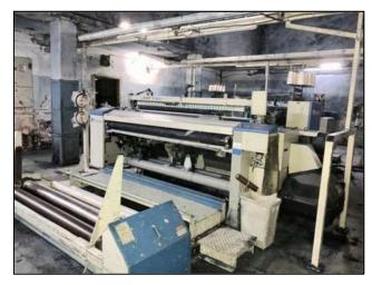
Fig.: Air jet power loom
